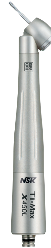
• Puissance : 21 W • Vitesse : 380 000-450 000 min -1 • Dimensions de la tête : ø11,2 mm x H 13,5 mm • Tête à angle de 45° • Pour des fraises Friction Grip (FG) très longues (25 mm) seulement
